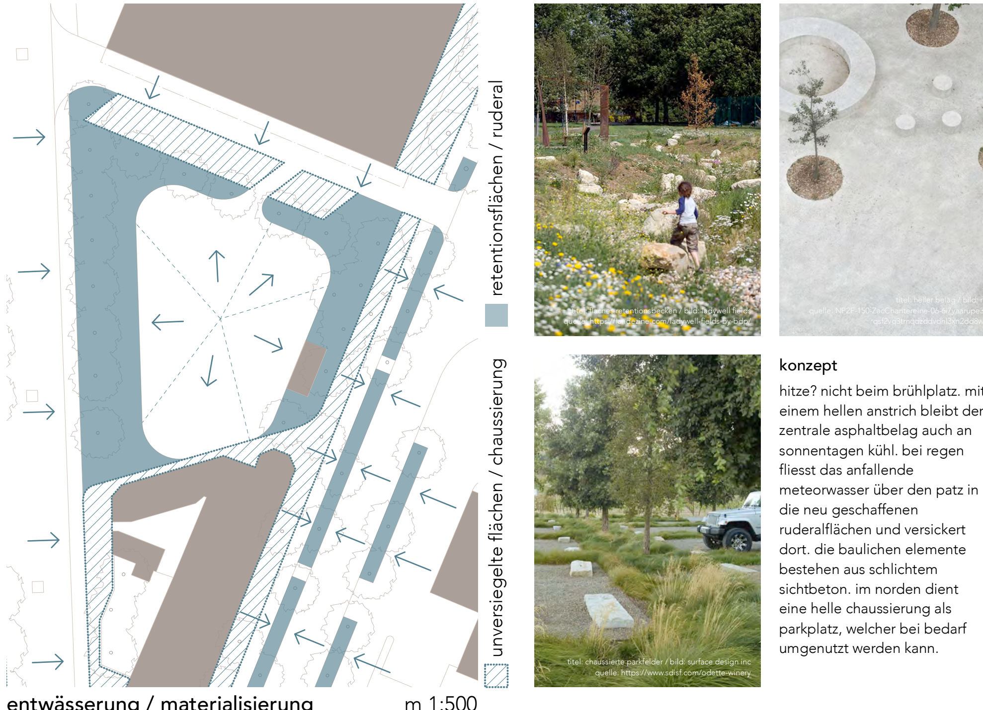
entwässerung / materialisierung m 1:500
